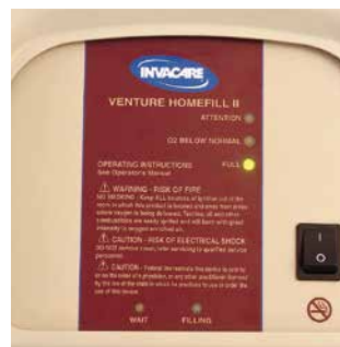
Panel frontal Indicaciones claras que indican el proceso de carga.
