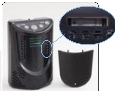
Filtro y contador horario
